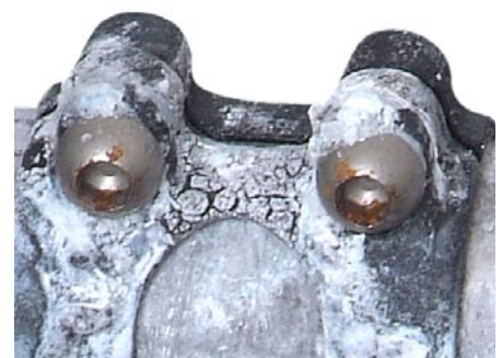
Dicke Salzkruste nach 400 Stunden heiß-feuchter Syntace STS-Folterkammer. Das Salz dient hauptsächlich zur Beschleunigung der Prüfung.
