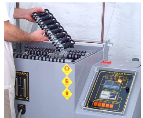
Syntace SCC-Prüfung im „Salt & Tension Stress Monster“: 8 Prüflinge des gleichen Modells werden unter starker Spannung in die Sprühkammer gehängt.
